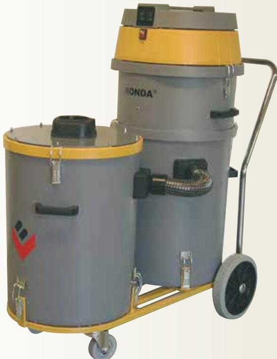
RONDA® 2-58 DUO er ideel, når man suger væsker med større mængder af partikler. Det kan både være små partikler som f.eks. slam eller større partikler, som f.eks. spåner. Maskinen adskiller de større partikler fra væsken, uden at brugeren behøver at bekymre sig om filterskift. F.eks velegnet til opsugning af kølevæske med metalspåner.
